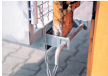
3 Bolzen zur Sicherung gegen Verschieben in Gabelängsrichtung
